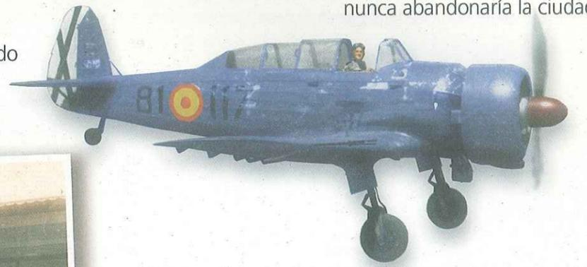
El HS-42 fue el primer avión proyectado y construido íntegramente en Sevilla. Diseñado por los ingenieros de La Hispano Suiza, era un avión de enseñanza y entrenamiento del se fabricaron 115 ejemplares en dos variantes principales, el HS-42 y el HA-43.
